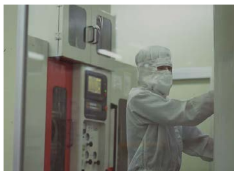
クリーンルーム内で充填する小袋包装無菌充填システム
